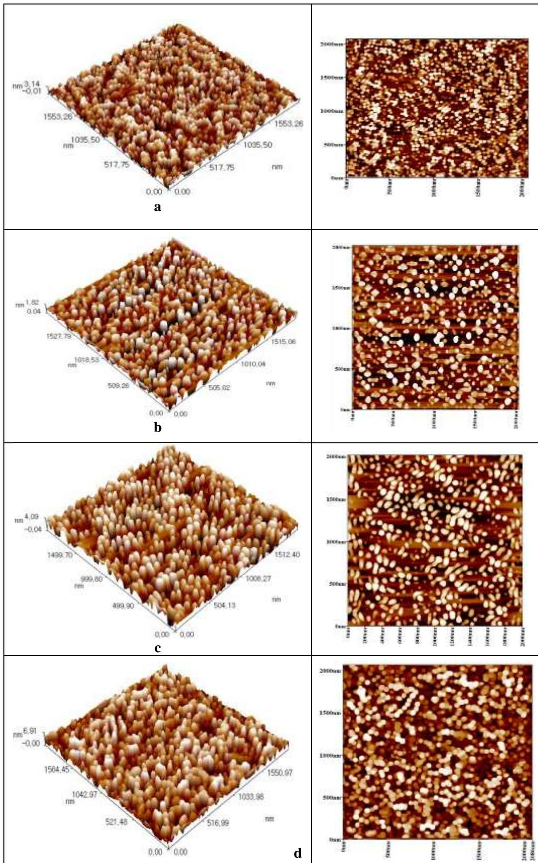
**Figure 6-**3D& 2D AFM images of (100:1) Alq3: C60 / PS thin film at (a) as-deposited  $T_a=373\text{ K}$  (c)  $T_a=423\text{ K}$  (d)  $T_a=473\text{ K}$
